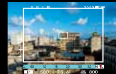
광학식 뷰파인더(OVF) 선명한 광학 이미지와 LCD 패널 정보 표시를 구성할 수 있습니다.
