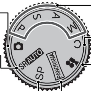
**P, S, A, M:** 조리개(M 및 A)와 셔터 스피드(M 및 S, 26 페이지)를 포함한 카메라 설정을 정밀하게 조절하기 위해 선택합니다.
