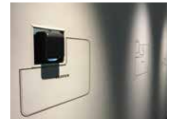
수직으로 프로젝터 설치 시 두께는 단 10.8센티미터. 벽면에 설치할 때 설계상 장점이 돋보임.
