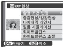
2 선택기를 위 또는 아래로 눌러 설정을 강조 표시한 후 오른쪽으로 눌러 선택합니다. 선택기를 위 또는 아래로 눌러 원하는 옵션을 강조 표시한 후 **MENU/OK**를 눌러 선택하고 설정 목록으로 돌아갑니다. 이 단계를 반복하여 추가 설정을 조정합니다.
